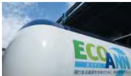
液化アンモニア出荷用ローリータンク
