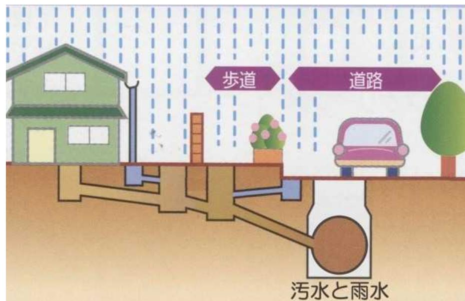
汚水と雨水を同一の管渠系統で排除
