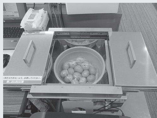
食品中の放射線を測定する機器
